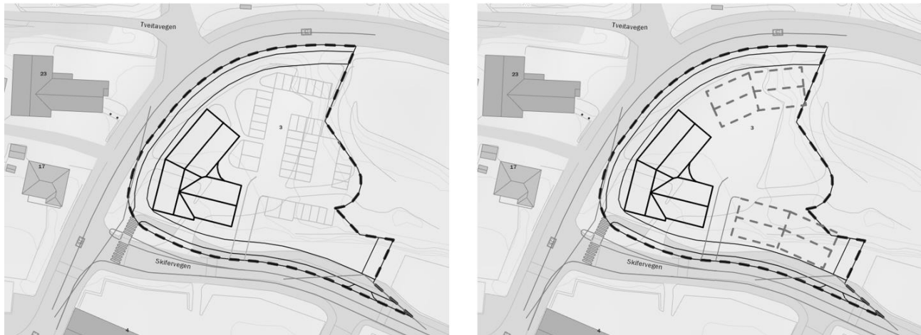
Figur 2.2: Figuren til venstre syner prinsipp for fyrste byggjesteg med nytt bankbygg og parkering. Figuren til høyre syner mogleg vidare utvikling av bygningsmassen innanfor planområdet med bebyggelse plassert i byggjegransene mot Skifervegen og Valdresvegen (E16).
