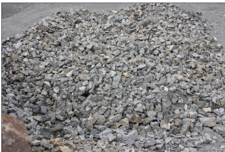
Figur 3-19: Egenskapene i fjellmassene i bruddet gjør de knuste masser meget godt egnet til vei, asfalt og kommunaltekniske anlegg.
