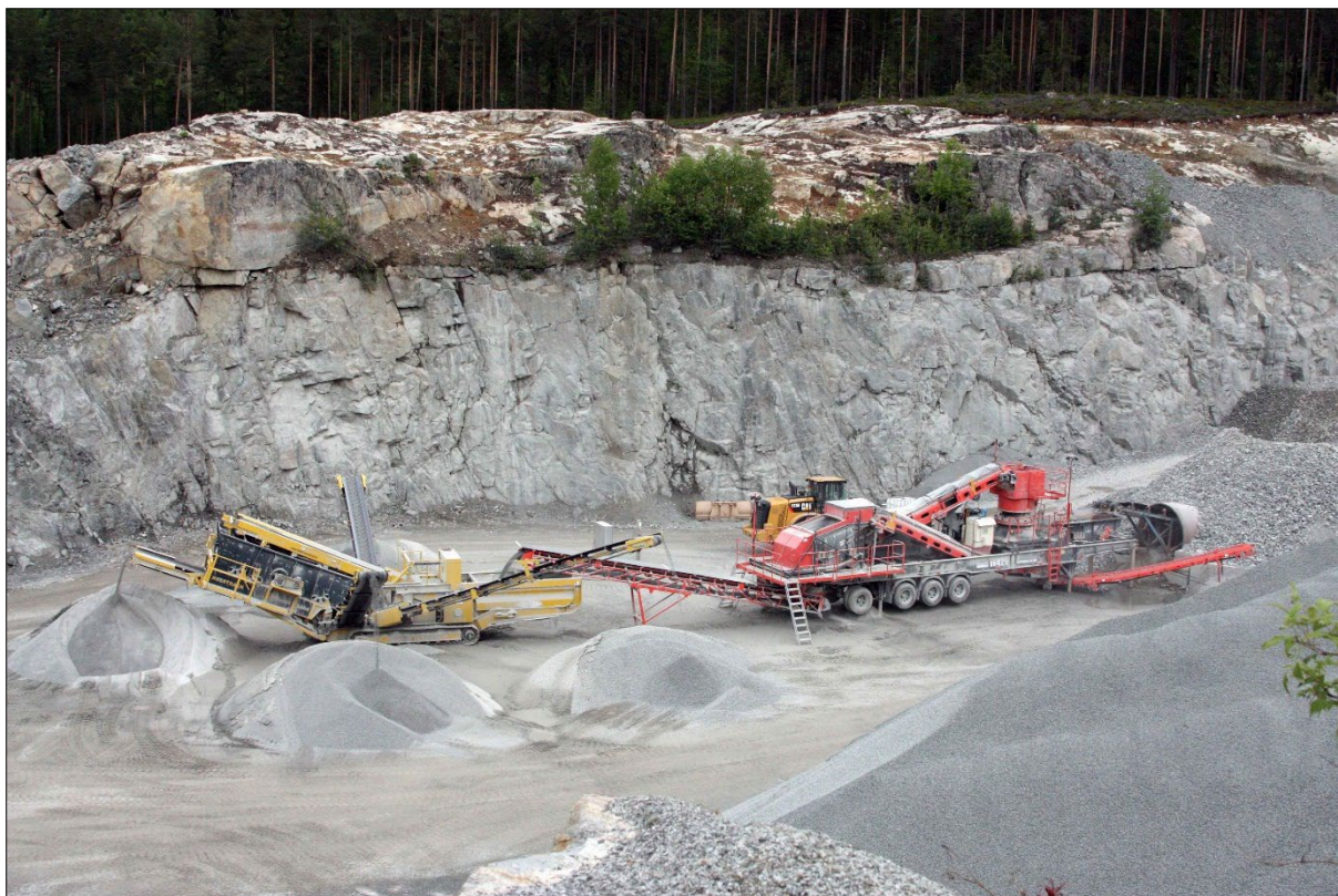
Figur 3-4: Det foregår knusing hele året. Her er det en finknuser med sikteverk. For å dempe støy og støvflukt er de gjerne plassert omgitt av fraksjonshauger og vegger i bruddet. Bruddveggen på bildet er mot nord.
