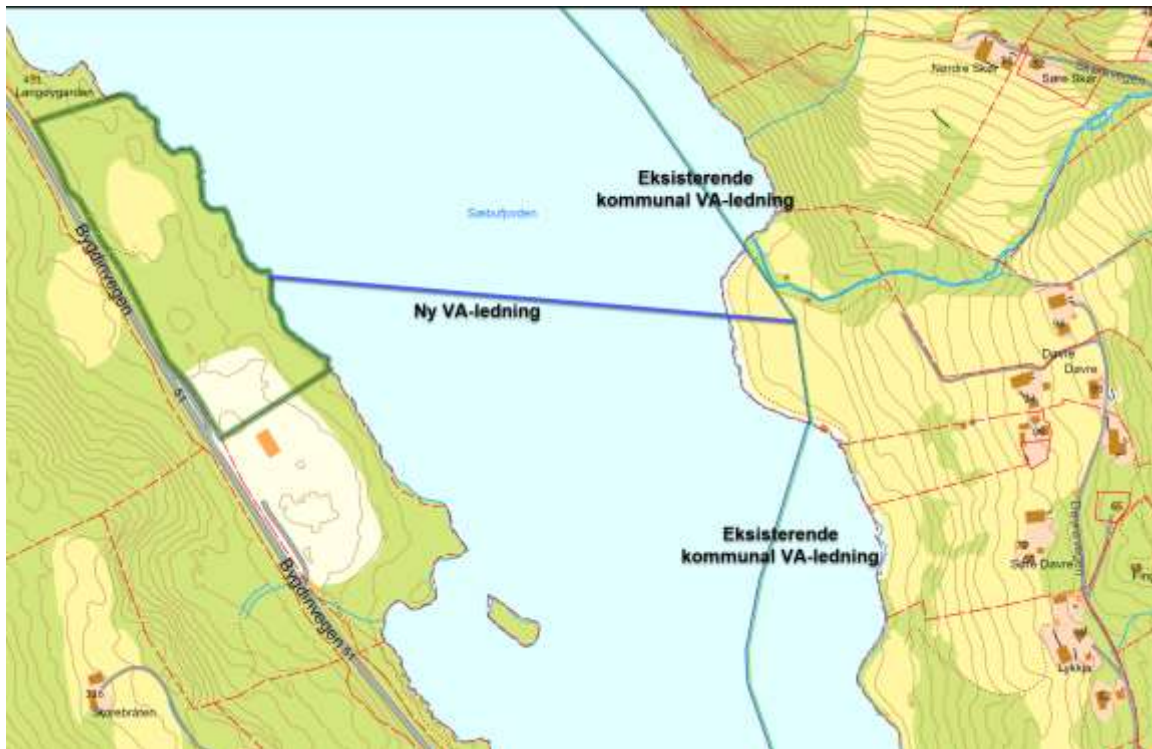
Eksisterende offentlig VA og planlagt VA
